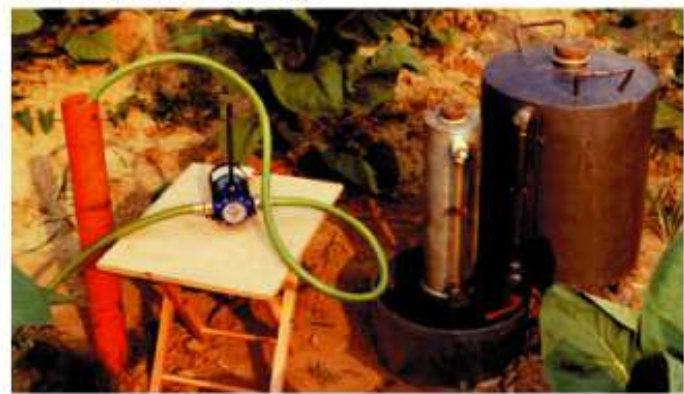
La permeabilità di campo si misura con il permeometro
